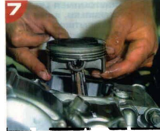
7 Remontage du piston. Lubrifiez-le abondamment avec de l'huile moteur non sans avoir au préalable effectué le tierçage des segments (voir manuel d'atelier spécifique à chaque moto). Puis remplacez minutieusement le piston dans le cylindre en pinçant délicatement les segments. Procédez ensuite à l'inverse du démontage pour replacer la totalité des pièces. Et resserrez tout au couple prescrit.
