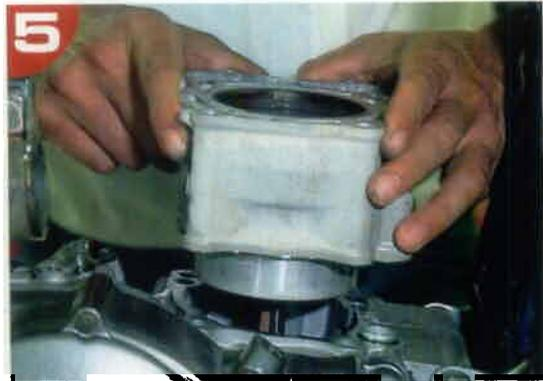
5 Ultime étape avant d'accéder au piston, le démontage du cylindre après avoir retiré sa vis de fixation.
