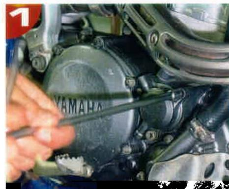
● Le filtre est toujours protégé derrière un carter qu'il faut démonter pour accéder au filtre à huile.
