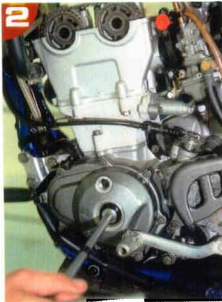
**2** Démontage des deux bouchons du carter d'allumage pour caler la distribution au point mort haut avec les repères du volant et des pignons d'arbre à cames.
