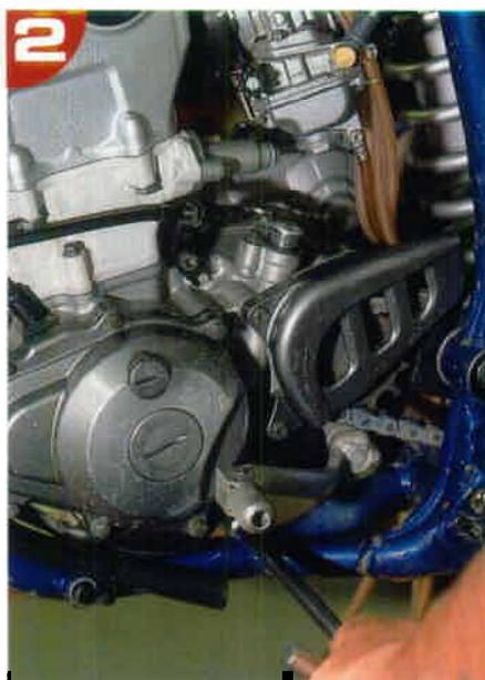
● Deuxième étape, le démontage de la vis de vidange, positionnée sur le côté du moteur sur la 250 Yam YZF.
