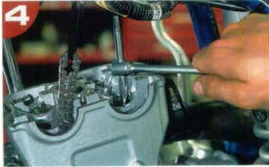
4 Démontage de la culasse en enlevant les quatre vis et les deux écrous qui la maintiennent.
