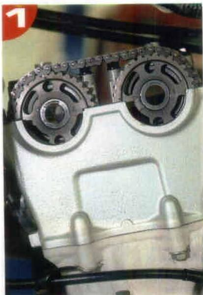
**1** Pour accéder aux soupapes, il est impératif sur de nombreux 4-temps de démonter le cache-culbuteurs (deux vis à ôter sur la 250 Yam YZ-F).
